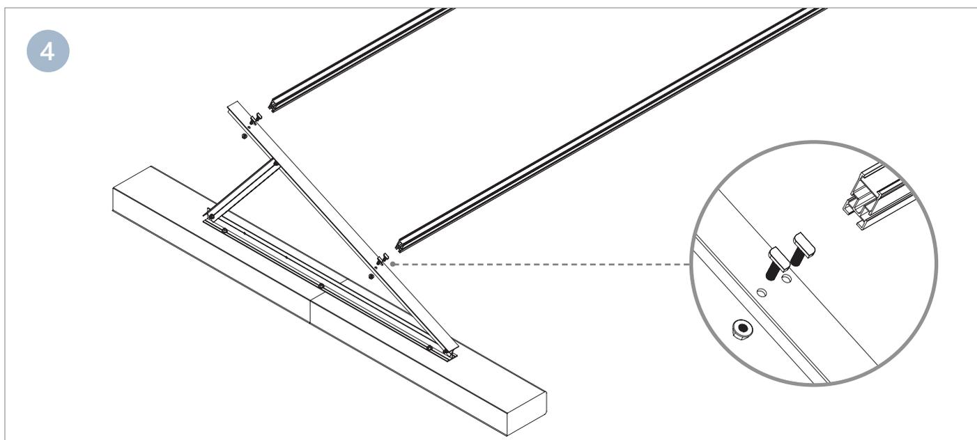
Fissare il profilo trave al triangolo utilizzando le viti testa a martello VT1001 e dadi flangiati VT0006.
