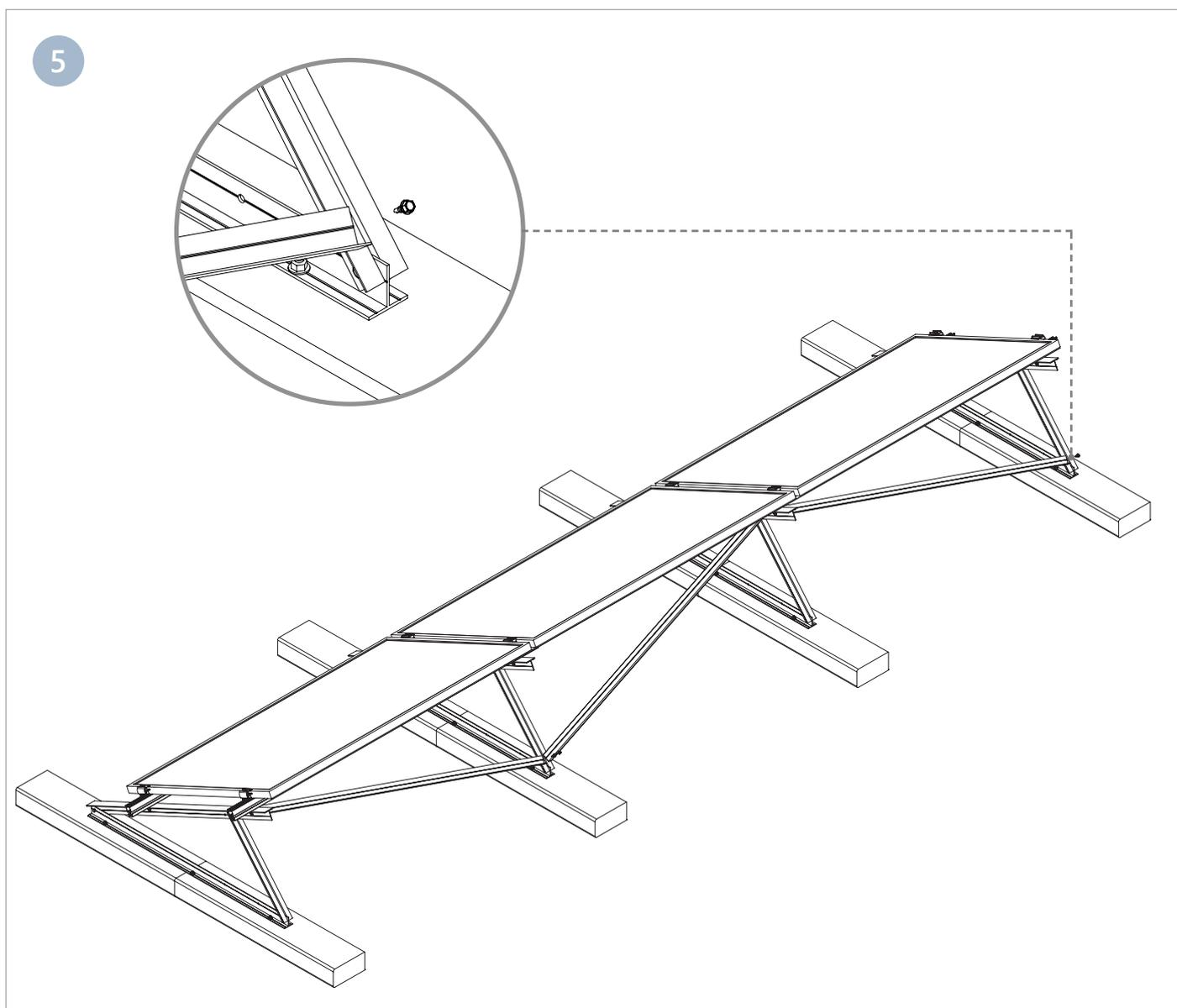
Installare i controventi posteriori **PRL1233** con le viti autoperforanti **VT0019**.
