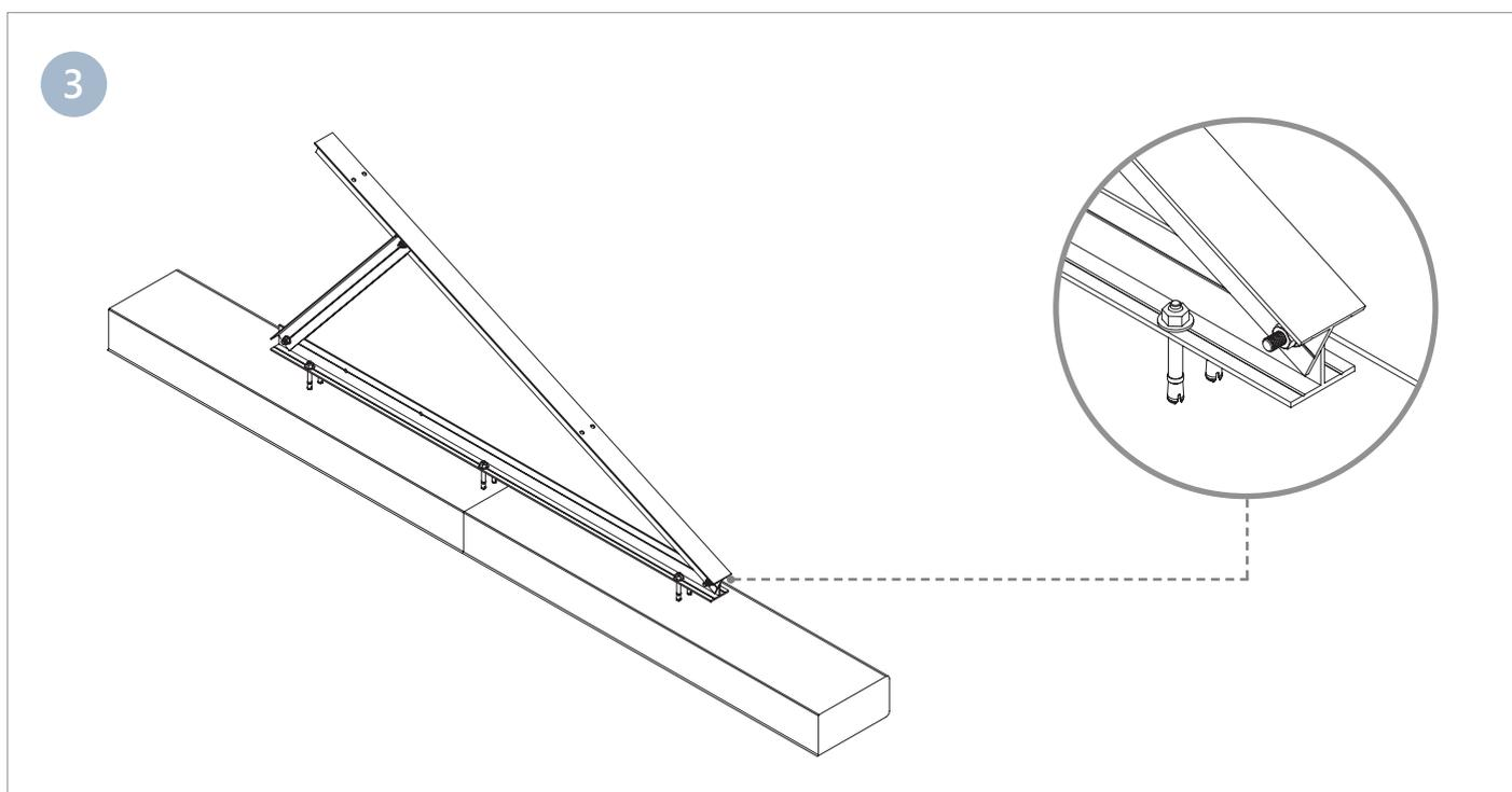
Forare la base del triangolo e la zavorra o il tetto e tassellare il triangolo alla zavorra o al tetto.
