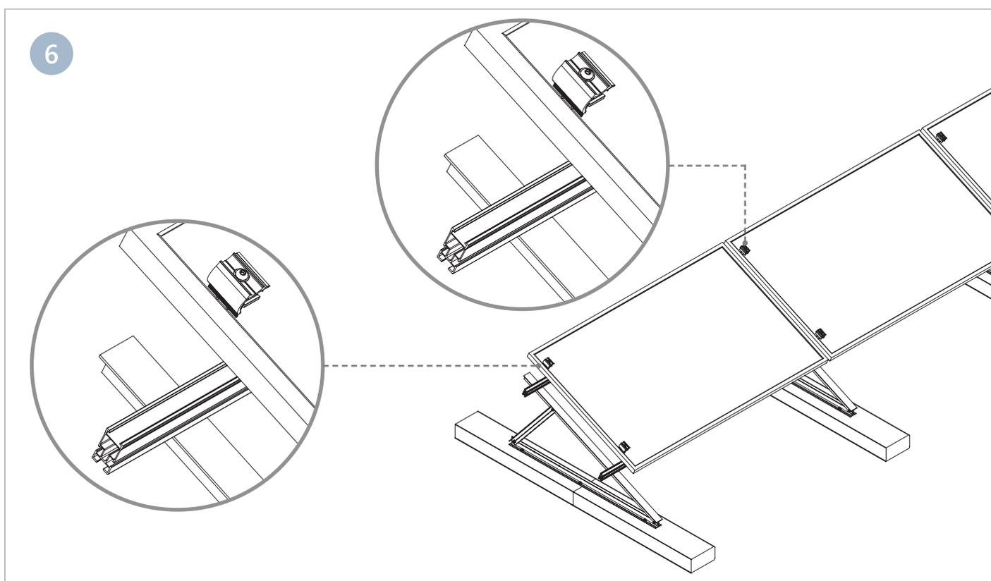
Installare i morsetti terminali e centrali sul profilo trave e posizionare i moduli fotovoltaici sulla struttura e fissarli tramite i morsetti.
