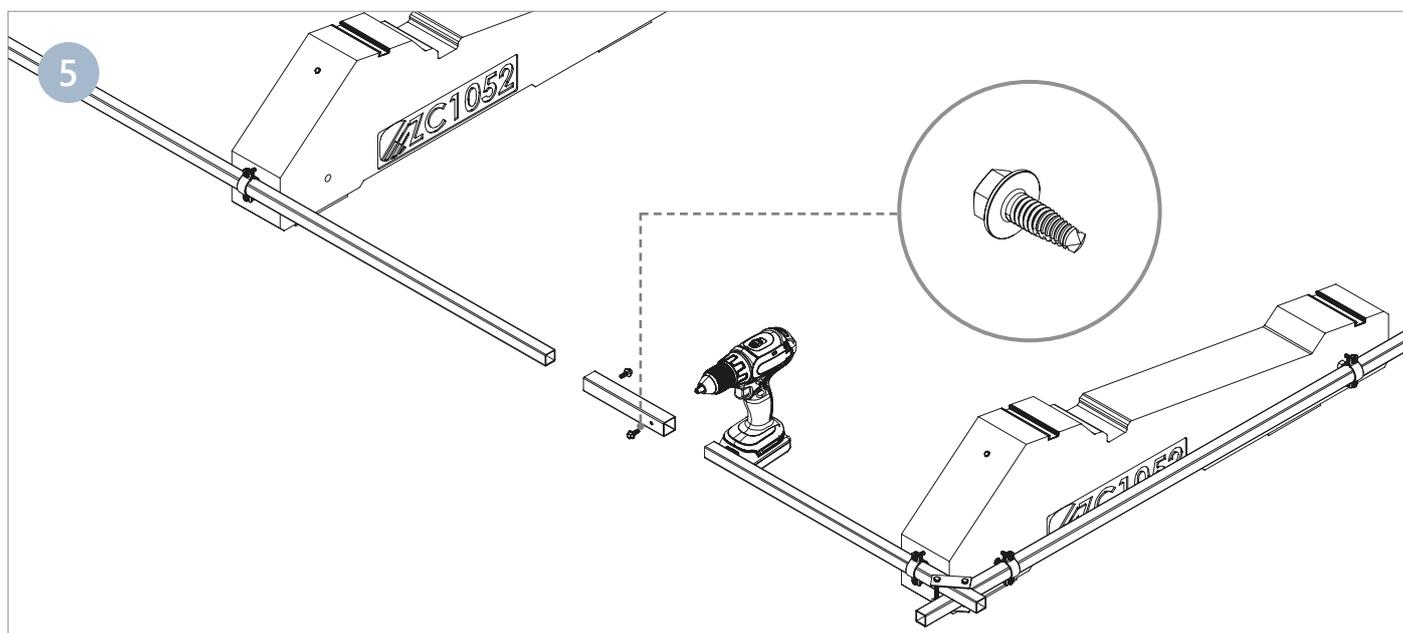
Effettuare all'occorrenza le giunzioni dei profili controvento laterali e posteriori con il profilo giunzione PRG3030Z utilizzando le viti autoperforanti VT1010.
