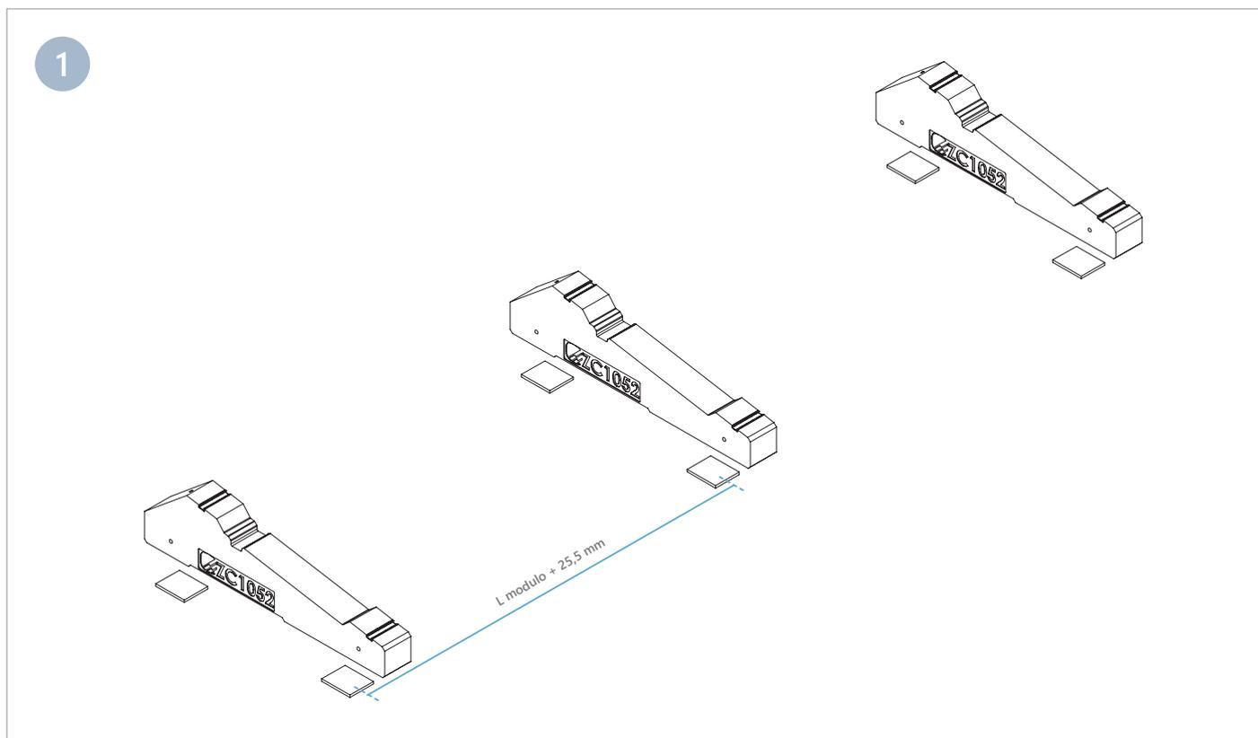
Posizionare i tappetini adesivi in EPDM ZTP1311 e le zavorre ZC1052 secondo il layout dell'impianto calcolando l'interasse in funzione della dimensione del modulo.
