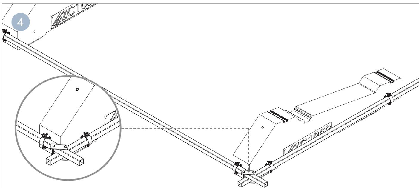
Installare controvento posteriore PRC2525Z-200 unendo gli incroci con il profilo laterale tramite il kit staffa KSTZ0006.
