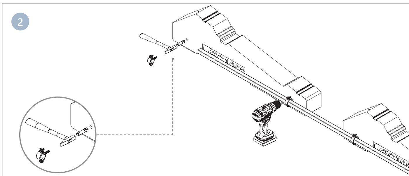
Installare collari laterali KZCLM8 utilizzando i fori predisposti ed installare controvento laterale PRC2525Z-200 unendo le file di zavorre dell'impianto.
