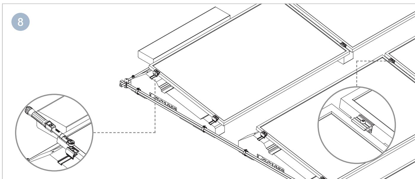
Serrare i morsetti terminali e centrali con una coppia di serraggio pari a 14 Nm.
